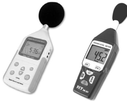
ภาพที่ 10 ภาพอุปกรณ์ช่วยทดสอบอุปกรณ์เสียงแจ้งสัญญาณ
