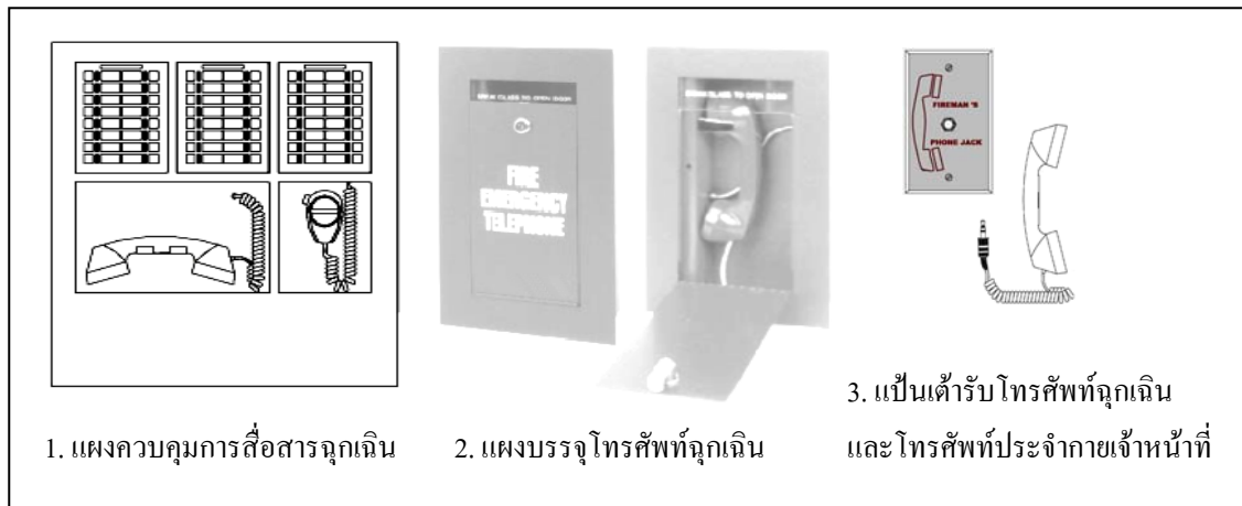
ภาพที่ 2.3 ชุดบริษัทควบคุมการสื่อสารฉุกเฉิน และ โทรศัพท์ฉุกเฉิน
